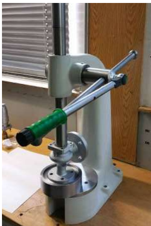
Étape 5 Mise sous Presse du clapet directement monté sur le corps de la soupape
