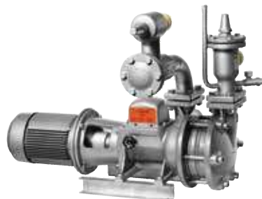
Pompe GP avec vanne aspiration, vanne/clapet de refoulement, robinet mano et tuyauterie de dégazage
