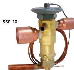
SSE-10 Train thermostatique N°83 Joint métal/métal Longueur standard de capillaire 1,5m
