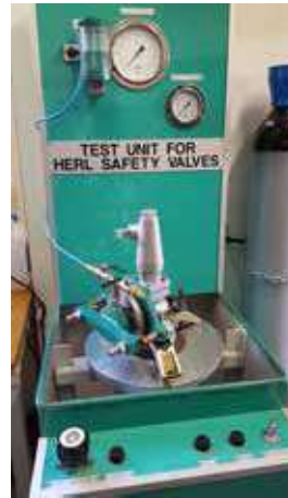
Étape 7 Tarage de la soupape de sécurité et contrôles
